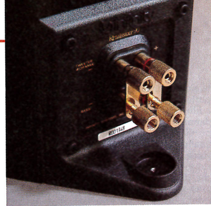
I morsetti di ingresso del segnale consentono il collegamento di cavi con ogni tipo di terminazioni. Essi inoltre consentono, rimuovendo le due placchette metalliche visibili in figura, il bi-wiring o la biamplificazione.
