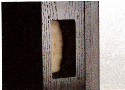
L'emissione posteriore del midrange EMIM viene controllata tramite una corta linea di trasmissione, in cui la porta posteriore, che si apre sul retro del mobile, è opportunamente smorzata. In questo modo, tramite la pressoché totale eliminazione della radiazione e delle riflessioni posteriori, si riduce la distorsione alle medie frequenze e si ottiene un elevatissimo smorzamento dei movimenti della membrana, con conseguente rapidissima risposta ai transienti.
